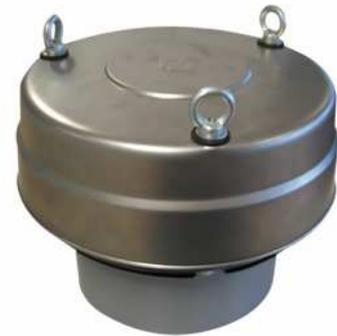
Las válvulas de control de presión con muelles, modelo VCP, están compuestas de un (cuerpo cilíndrico montado mediante una brida y cuello, que se suelda al silo), cuerpo metálico interno, el cual está formado por un disco de cierre con un muelle central para condiciones de depresión, un anillo externo para condiciones de sobre presión y una protección en la parte superior.
